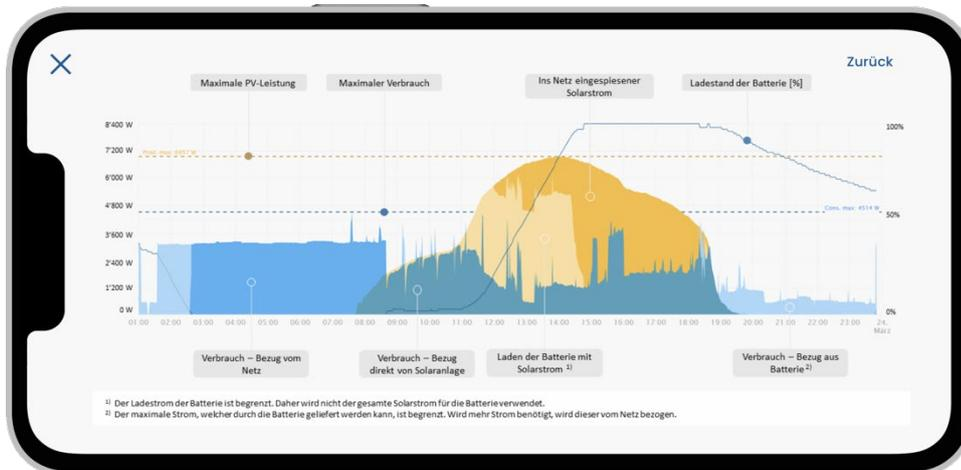
Das Helion ONE unterstützt die Anbindung von Batterien. Dabei wurde auch die Visualisierung erweitert. In der nachfolgenden Abbildung ist die Bedeutung der einzelnen Farben beschrieben.
