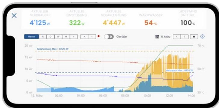
Abbildung 1: In der Grafik ist in braun der Leistungs-Verlauf einer geregelten Ladestation (braune Linie) und eines geregelten Heizstabes (violette Linie) zu sehen.
